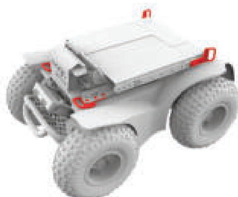
Rys. 5.4d Extreme X8 - punkty mocowania
