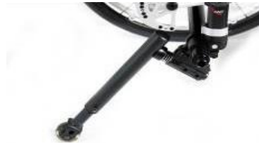
KRR090033 Podnoszone kółko anti-wywrotne
